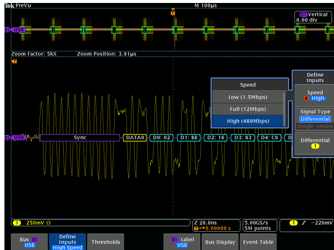
Decodierte High-Speed-USB-Anzeige, automatische Anzeige des Businhalts.
