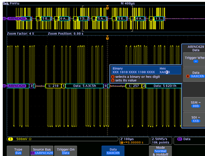
Triggering auf einem bestimmten Datenwert auf dem ARINC-429-Bus.
